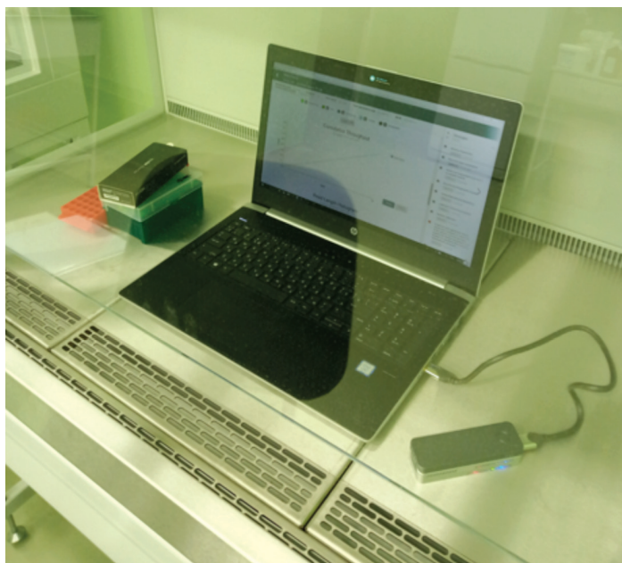
Рис. 1. Секвенатор MiniON и компьютер для обработки данных размещены в боксе биологической безопасности.
